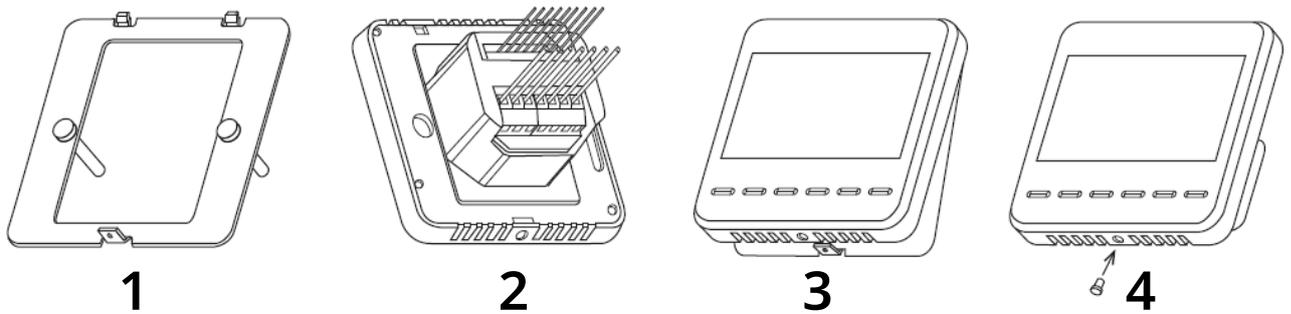
Beiliegendes Montagezubehör: Montageplatte, kleine Schraube und Kunststoffkappe zum Schutz der Frontplatte bei der Montage oder Renovierung. Die Montageplatte (1) erlaubt das Befestigen des Geräts auf der Wand, ohne dass es geöffnet werden muss.
