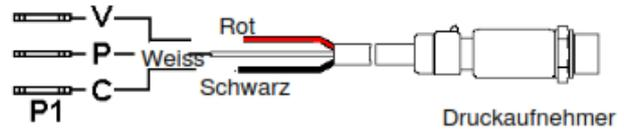
Es können ein oder zwei Druckaufnehmer vom Typ P499VCx-405C angeschlossen werden. Die Druckaufnehmer haben ein Ausgangssignal von 0 bis 10 V DC.
