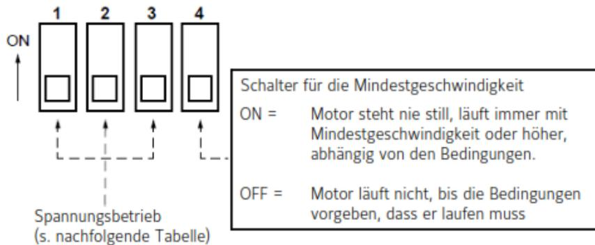
Die 4 DIP-Schalter sind intern am Port A des Mikroprozessors angeschlossen:
