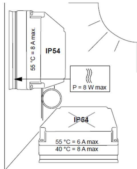
Für eine ausreichende Luftzirkulation sollten mindestens 10 mm um dem Regler herum als Freiraum vorgesehen werden. Wenn der P216 in einem Schaltschrank eingebaut wird, müssen Lüftungsslitze vorhanden sein. Kann die Montage des P216 nicht vertikal erfolgen, gelten weitere Einschränkungen.
