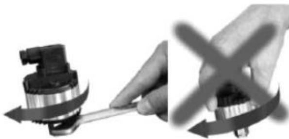
Verwenden Sie immer einen Maulschlüssel der Schlüsselweite 19, um den Drehzahlregler festzuziehen (Style 47). Ein Festziehen von Hand ist nicht erlaubt.
