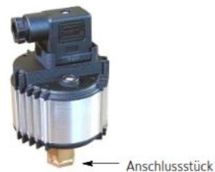
Bei einer Montage von Hand kann sich das Gehäuse relativ zum Anschlussstück verdrehen. Dadurch wird der Drehzahlregler nicht beschädigt, aber der werkseitig eingestellte Sollwert kann sich verschieben.
