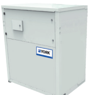
YWH Wasser-Wasser-WP Scroll Verdichter / R134a Warmwasser bis zu 78°C Heizleistung: 38 bis 273 kW
