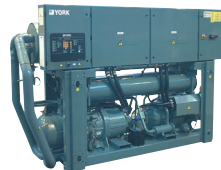
YLCS Wasser-Wasser-WP Zweikreis Schraube / R134a Warmwasser bis zu 65°C Heizleistung: 440 bis 990 kW
