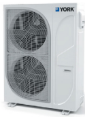
YVAG Luft-Wasser WP Scroll Verdichter / R410A Warmwasser bis zu 52°C Heizleistung: 10.9 bis 18.4 kW
