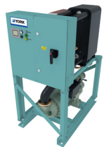
YCSE Wasser-Wasser-WP Schrauben-Verdichter / R134a Warmwasser bis zu 55°C Heizleistung: 170 bis 300 kW
