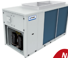
YCZ Luft-Wasser WP E.V.I Radiallüfter / 4-Rohr System Scroll E.V.I Verdichter / R410A Warmwasser bis zu 65°C Heizleistung: 26 bis 73 kW
