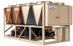
YLPB Luft-Wasser WP Scroll Verdichter / R410A Warmwasser bis zu 52°C Heizleistung: 344 bis 653 kW
