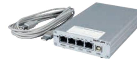
800-Anlage weiter. Rufbearbeitung und Durchsagen mit Telefon möglich. Für die Anzeige von Rufen auf dem Telefon ist ein externer Alarmserver oder Software-Erweiterung für ESPA-X-Protokoll für Telefon-Interface IP nötig. In der Telefonanlage muss nur eine Rufnummer (Querverbindungsnummer) dem Telefon-Interface IP zugeordnet werden.
