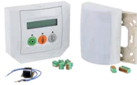
LED-Signalleuchte ohne Elektronik zur Anzeige von Anwesenheiten, Normalrufen, Notrufen und Alarmrufen in verschiedenen Signalformen (Blinkmuster) nach DIN VDE 0834. 4 Leuchtfelder mit LEDs. Farben weiß, rot, grün, gelb/blau. Das 4. Leuchtfeld kann 2 Farben signalisieren: Gelb für Anwesenheit 2, Sonderruf, Sondernotruf oder blau für Herzalarm.
