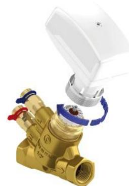
Für die Montage des Antriebs VA-748x auf das Ventil VP1000 kompakt (DN 15 bis DN 32) wird standardmäßig ein passender Adapter aus Messing (Bestellzeichen OA7010 für Ersatz) mitgeliefert.
