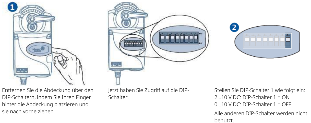
Abbildung 9: Antrieb VA9905 für VG1600 Einstellen der DIP-Schalter für die Auswahl des Eingangssignals
