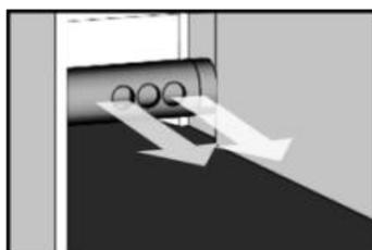
Die Strömungsrichtung kann von rechts oder links erfolgen.
