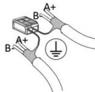
Bei durchgeschleifter RS485 Verkabelung beide Kabelschirme mittels der beiliegenden pol. Klemme wie dargestellt verbinden.
