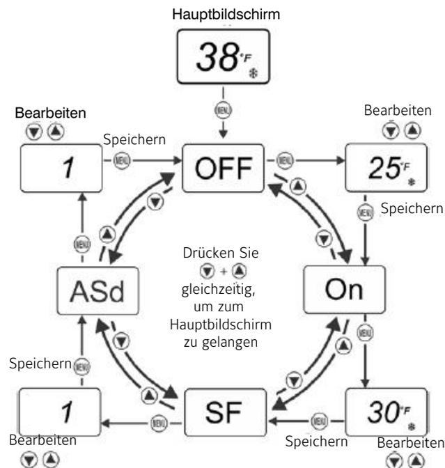
Im Basismenü können Sie schnell die Temperaturwerte für die Parameter OFF und On bearbeiten, die Aktion SF für das Relais bei einem Fühlerausfall und die Verzögerung ASd gegen eine zu kurze Zykluszeit festlegen.
