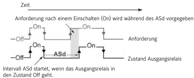
Wenn der Wert ASd größer als 0 ist, wird das eingestellte Verzögerungsintervall jedes Mal initialisiert, wenn der A421 eingeschaltet wird, oder ein OFF-Zyklus beginnt. Wenn das Intervall aktiv ist, wird abwechselnd der Messwert am Fühler A99 und ASd auf dem Display angezeigt.
