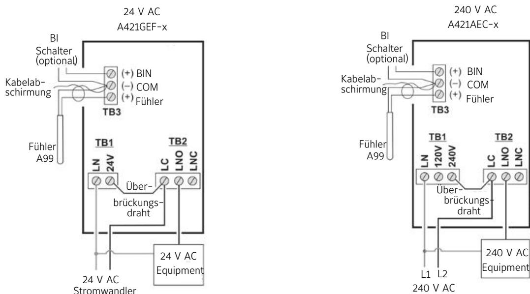
Klemmleiste TB2 und Ausgangsrelais vom Typ 1-poliger Wechselkontakt
