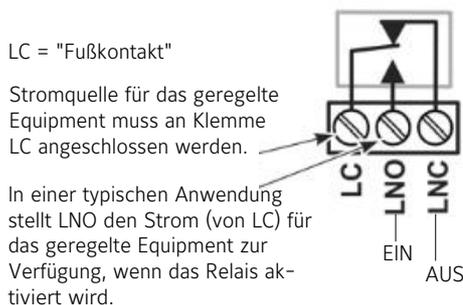
Die Klemmen LC, LNO und LNC der Klemmleiste TB2 sind mit dem 1-poligen potentialfreien Wechselkontakt des Relais in der A421-Regelung verbunden. Das Thermostat stellt keine interne Spannung für die Klemmen oder Relaiskontakte an der Klemmleiste TB2 zur Verfügung.
