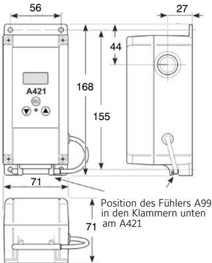
Nutzen Sie die 4 Löcher in den Ecken des Gehäuses für die Montage auf einer ebenen Wandfläche.
